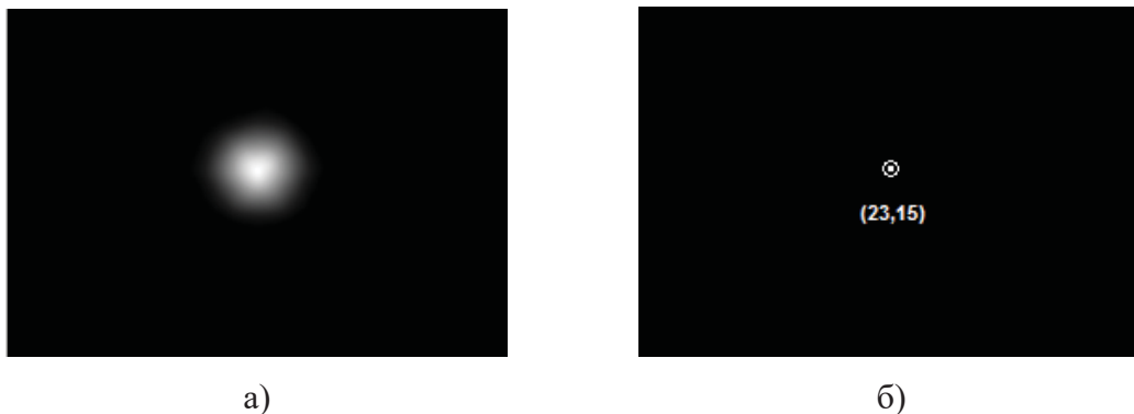
Рис.4. Изображения пластикового диска в песке, а) результат обработки согласно (9); б) бинарное изображение согласно (10).
