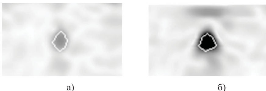
Рис. 3. Радиолокационные изображения пластикового диска при различных значениях коэффициентов усиления передающей и приемных антенн: а) G_{пер} = G_{пр} = 2 дБ; б) G_{пер} = G_{пр} = 6 дБ.
